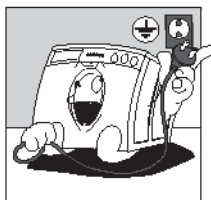
Стиральная машина должна быть подключена к соответствующей правилам безопасности электрической розетке с заземлением.
